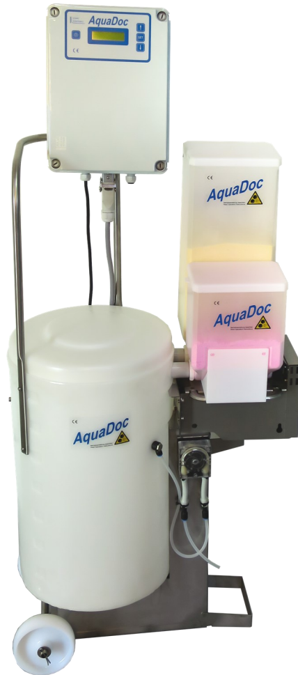
Mobile Ausführung des Aquadoc mit zwei Dosierbehältern für pulverförmige Zusatzstoffe und einer Dosierpumpe für flüssige Komponenten.
